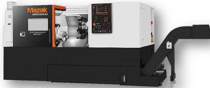
MAZAK QT 200MYL Course axe X : 215 mm Course axe Y:100 mm Course axe Z : 605 mm
